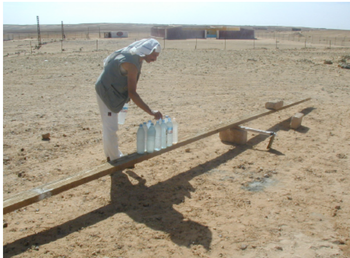
68. Rudimentale bilancia per misurare il peso unitario dei mattoni di terra.
