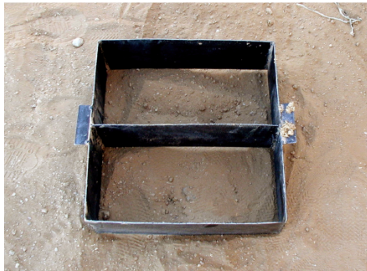
23. Stampo metallico per mattoni in terra cruda di dimensioni 40 x 20 x 10.
