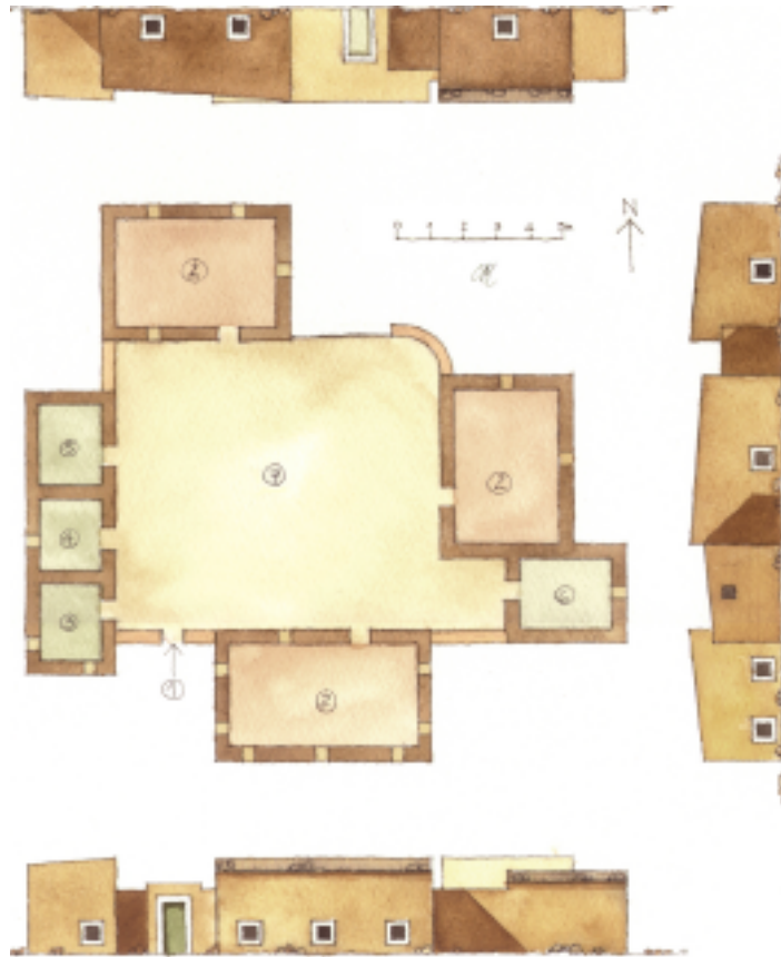
29. Pianta e prospetti di una casa Saharawi, la casa di Hatra. La tipologia a corte protegge dal vento e crea zone d'ombra. Le stanze sono funzionalmente intercambiabili e facilitano il “nomadismo interno” a fini climatici.
